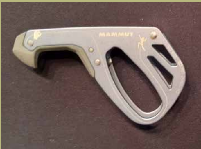
Foto 3 Blokkerende zekerapparaten Mammut Smart
