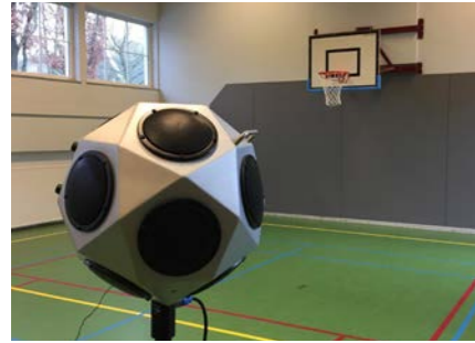
Foto 3 en 4 Luidsprekers voor metingen van de akoestiek, links: bolbron, rechts: spraakbron
