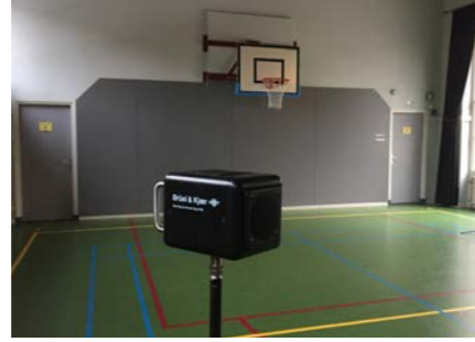
Foto 3 en 4 Luidsprekers voor metingen van de akoestiek, links: bolbron, rechts: spraakbron
