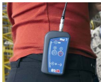
Foto 1 en 2 Plaatsing microfoon (links) en dosimeterkastje (rechts) voor geluidbelastingmetingen (Acoemgroep, 2014).
